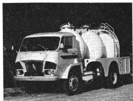
SOVAP : équipement de camion de ramassage de lait avec trois citernes sphériques de 2.000 litres
