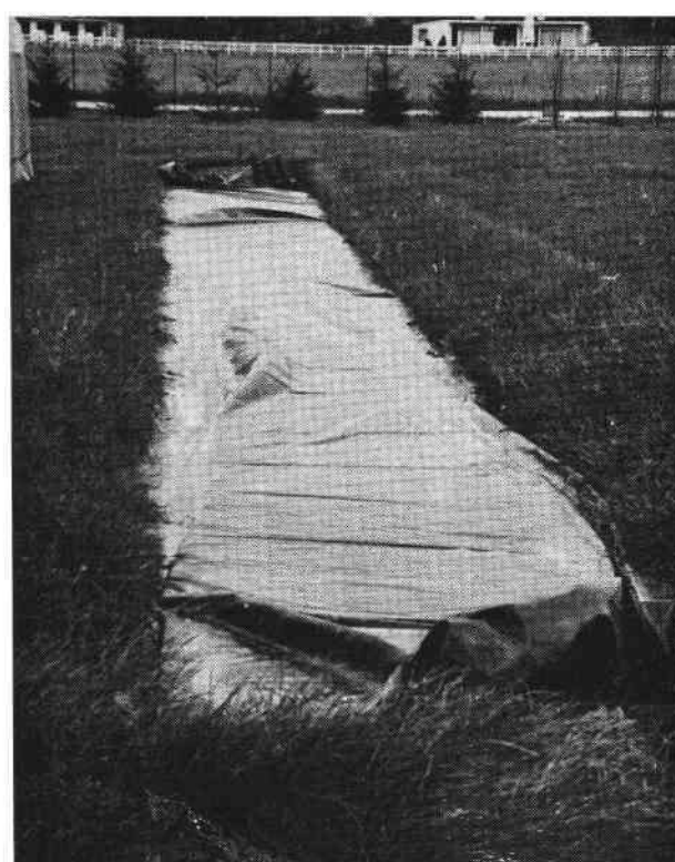
Stockage de liquide dans une gaine P.E. noire
